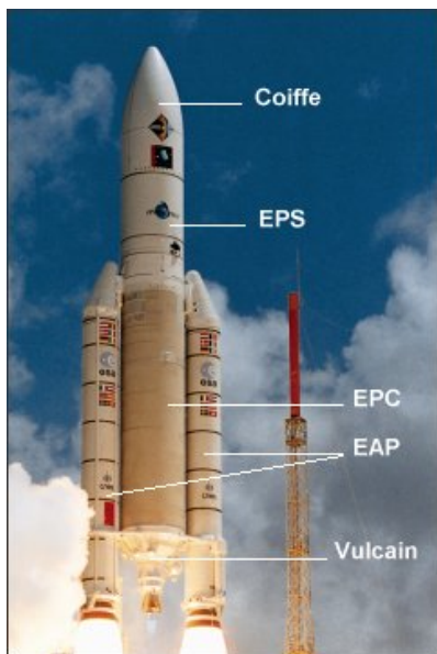
Principaux éléments d'Ariane 5
